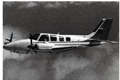
ビーチ社が戦後1949年後続機、高級ビジネス機として50型ツインボナンザとしてビーチ18型を前輪式にして垂直尾翼を大きな角型にして片発飛行を容易にし、18型では450馬力あったエンジンを小型の260馬力エンジンに変更し経済性を高めた。日本では新聞社が全社導入したほど、主に取材飛行で活躍した。
