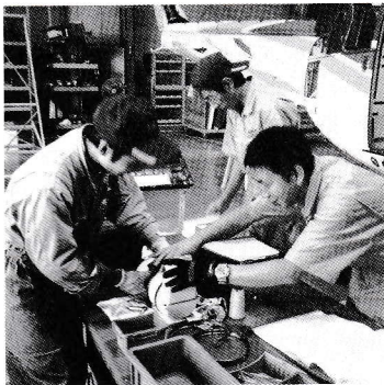
スタータージェネレーター点検
