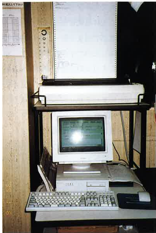
本田航空にあるサテライトシステム端末 入力したい内容は印字されて残るので確認できる。
